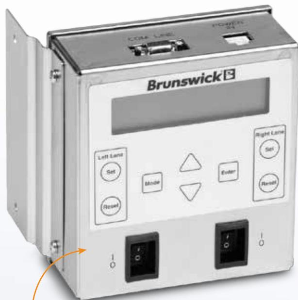
Un boîtier électronique connecté à l'arrière permet d'afficher tous les diagnostics.
